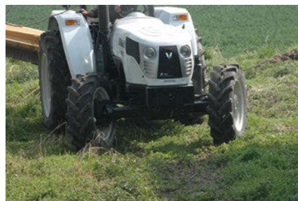
■ Sterzata non eccezionale per il nuovo compatto di Valtra: quasi 5 metri di raggio dichiarato dal costruttore.
