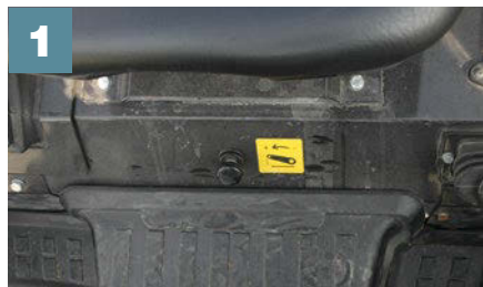
1. Chiusura di sicurezza del sollevatore posteriore sistemata sotto il sedile.
